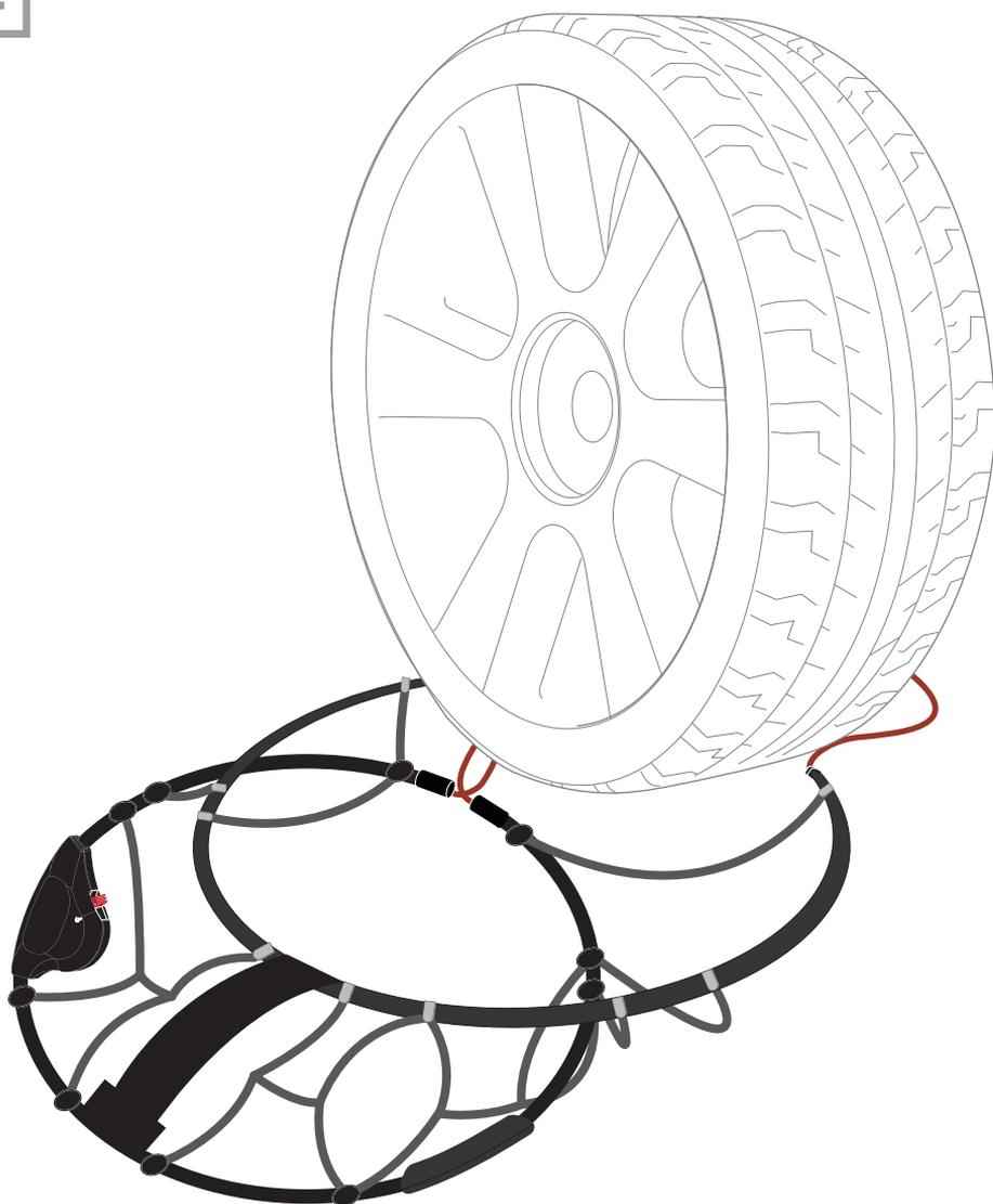
**IT** Una volta sfilata completamente, appoggia la catena a terra.
