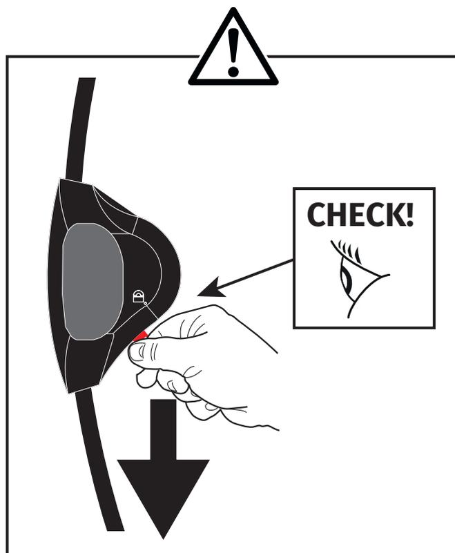
**IT** Verifica che il cursore presente sul dispositivo di tensionamento sia nella posizione bassa, in questo modo sarà possibile sbloccare il tensionamento ed eseguire le operazioni successive.
