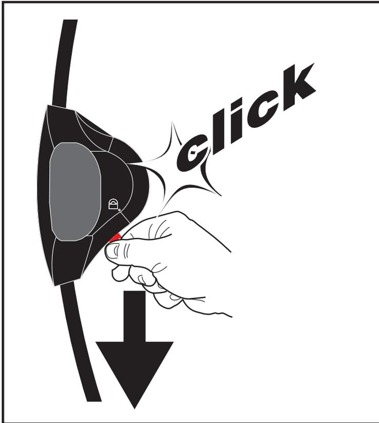
**IT** Rilascia il tensionamento, spostando il cursore del dispositivo di tensionamento nella posizione di sblocco.
