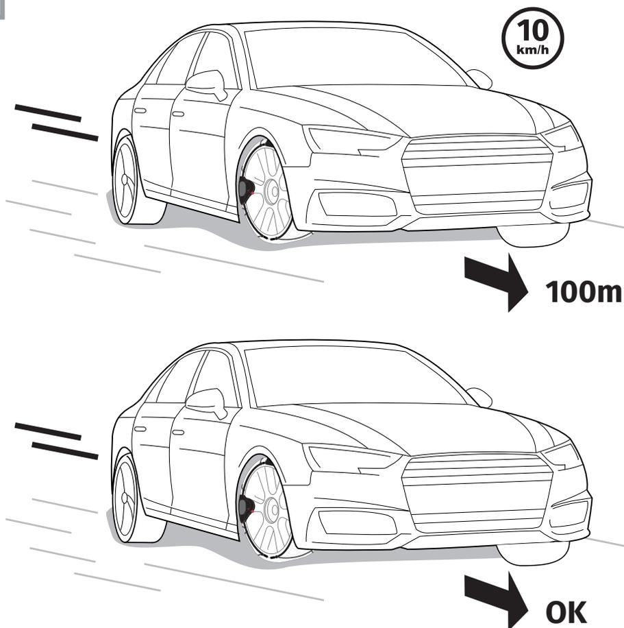
**IT** Ora puoi partire con il veicolo, percorrendo almeno un centinaio di metri a a bassa velocità, mentre la catena raggiunge il livello di tensionamento definitivo.
