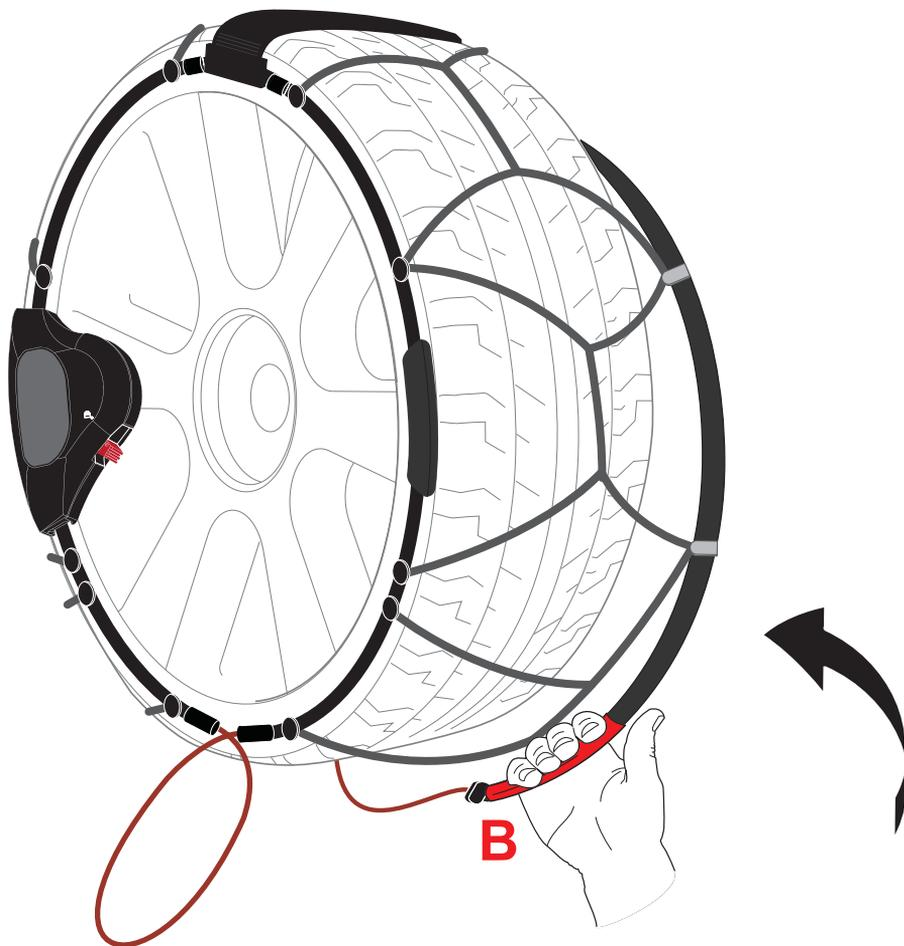
**IT** Impugna una delle due estremità (B) dell'arco rigido interno e sfilala dallo pneumatico, tirandola verso l'esterno.
