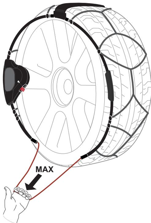
**IT** Impugna le due estremità dell'arco esterno e tirale verso di te per ottenere la fuoriuscita del micro-cavo. Per facilitare l'operazione, puoi tirare direttamente il micro-cavo rosso per farlo fuoriuscire dall'arco esterno.
