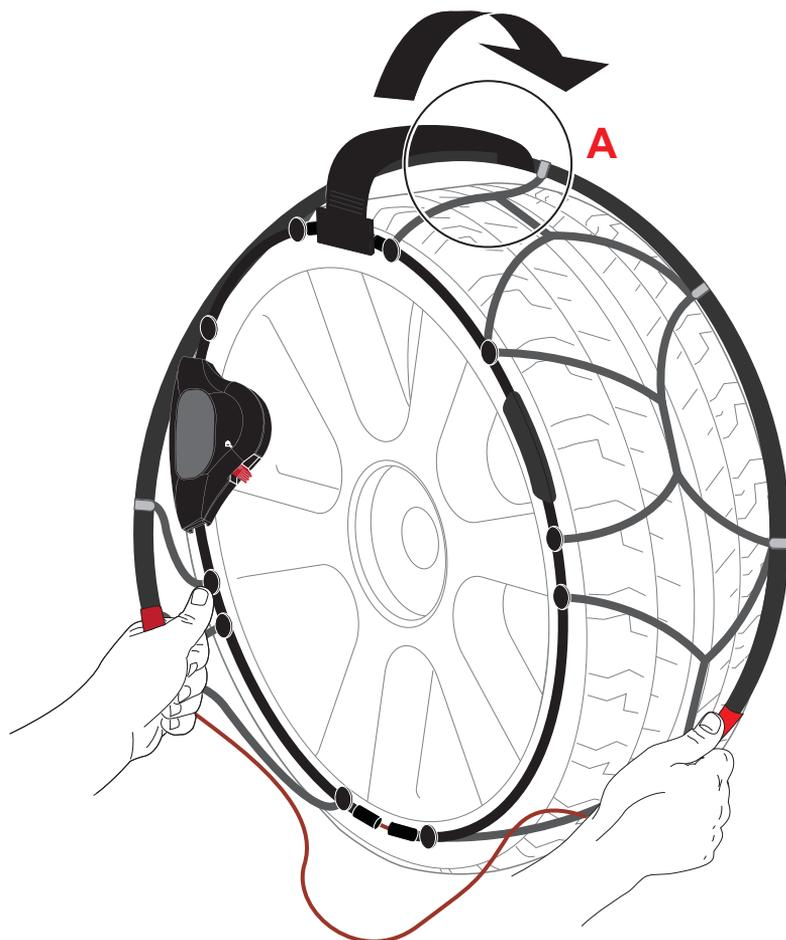
**IT** Tenendo le estremità dell'arco interno divaricate, calza la ruota partendo dalla parte alta. Idealmente devi posizionare la parte interna del by-pass (A) a ore 12:00 sulla spalla interna.
