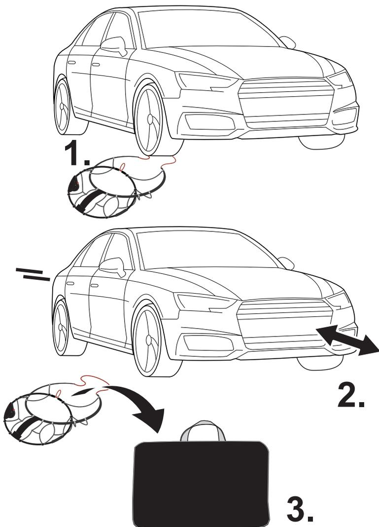
**IT** Muovi il veicolo lo stretto necessario per liberare la catena da sotto la ruota. Puoi muovere il veicolo sia in avanti che indietro.
