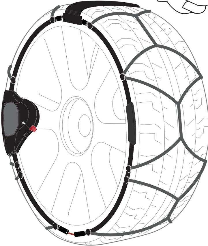
**IT** La catena è correttamente installata ed il tensionamento è attivato.
