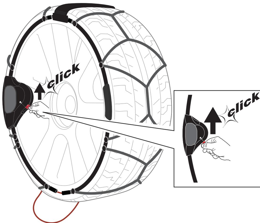
**IT** Aziona il tensionamento, spostando il cursore del dispositivo di tensionamento verso l'alto (posizione con lucchetto indicato).
