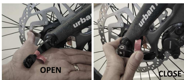
Aperto do dispositivo de liberação rápida
