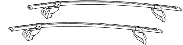
La capacité maximum de charge autorisée sur les barres de toit est de 50Kg répartis uniformément. Reportez-vous au manuel d'utilisation du véhicule pour connaître la charge maximale admissible par le pavillon du véhicule.
