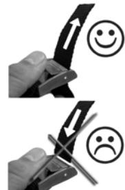
*Passer les sangles de serrage (H) et (I) à travers les roues et attraper les fourches avant des vélos, elles empêchent la perte des vélos et assurent le maintien ferme des vélos sur l'armature. Ne pas laisser « flotter » les sangles au vent, utiliser un élastique.*
