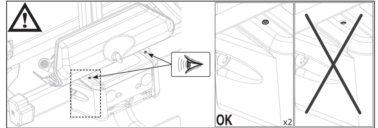
**FR** Pré-serrer les écrous pour obtenir une force de serrage de 30 kg sur les leviers.
