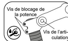
Vis de blocage de la potence : 14–16 Nm
