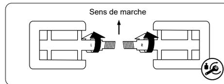
Avant de monter les pédales, enduire leur filetage de graisse.
