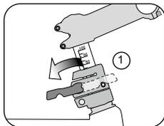
2. Tourner le guidon de 90° jusqu'à voir et entendre le blocage s'enclencher. L'axe de verrouillage est bien visible (2) sur la potence.
