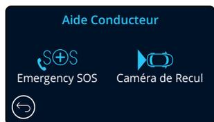
Pour que cette option fonctionne, l'application « MyNextbase Connect™ » doit être installée sur votre smartphone (ou tout appareil similaire), vous devez disposer d'une connexion Internet et de la fonction Bluetooth activée. L'application « MyNextbase Connect™ » peut être téléchargée à partir d'App Store® ou de Google Play®. Utilisez les codes QR ci-dessous ou recherchez « MyNextbase Connect™ » dans la boutique concernée.
