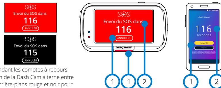
Pendant les comptes à rebours, l'écran de la Dash Cam alterne entre les arrière-plans rouge et noir pour être aussi notable que possible.
