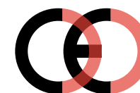
Faux marquage CE (trop proche)
