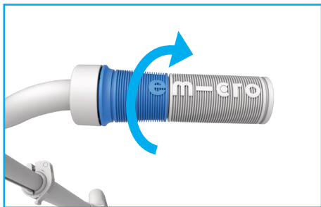
Image : Sens de rotation pour le frein à récupération
