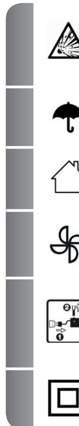
Gazy są wybuchowe. Urządzenie zawiera wyłączniki - ręczny i samoczynny - które mogą powodować powstawania iskier. Podczas podłączania akumulatora wytwarzają się iskry, które mogą grozić wybuchem! Jeżeli prostownik jest używany w garażu, należy umieścić go w specjalnym miejscu przeznaczonym do tego celu.
